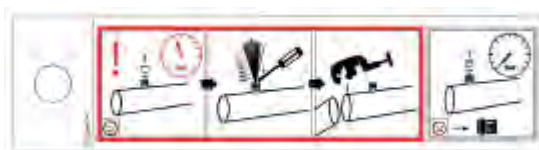
940 – Ostrzeżenie „Urządzenie napełnione na czas transportu” przy zaworze Schradera
